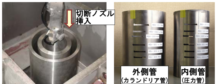
二重管と切断ノズル (二重管内側から切断) 二重管の同時切断結果 (Zr合金鋼)
