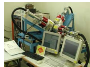
バックグラウンドを低減するために複数の検出器を組み合わせた多重γ線測定装置
